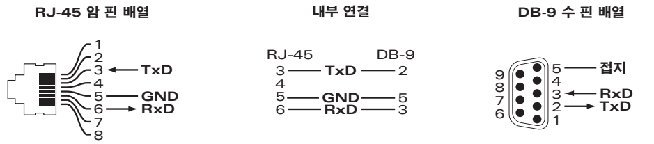
그림 5 RJ-45(암)를 DB-9(수)로 모듈 어댑터 전환
